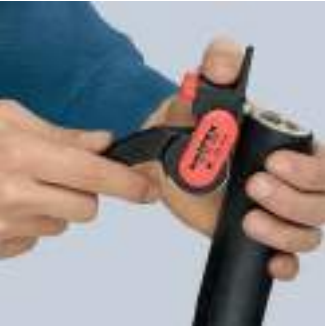
Colocar la herramienta para corte longitudinal
