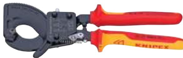
Efecto carraca, posibilidad de dos velocidades, para un corte más fácil
