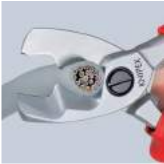
Corte final: Después de haber cortado el aislamiento del cable con el filo delantero, los conductores se cortan en el perfil trasero. Corte inicial delante, corte final atrás – de este modo se corta con más facilidad
